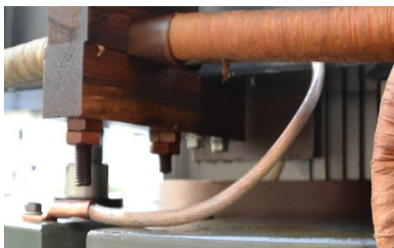
图 5 将原短接片更换为带有绝缘套的软铜导线
