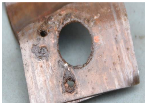
图 3 短接片上有 2 个小洞
